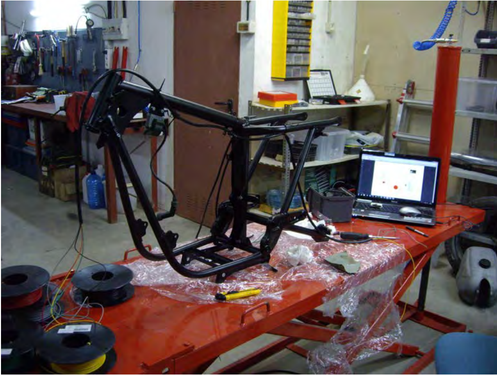
Cablejat nou de la moto
