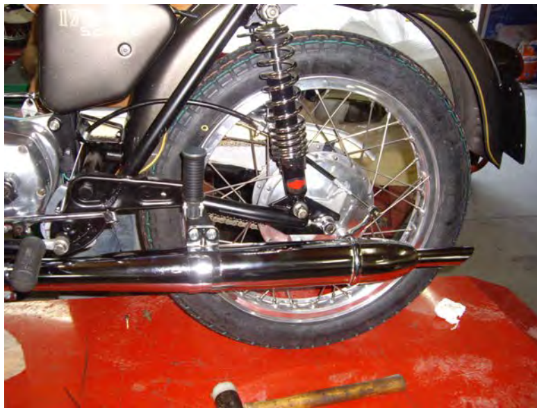
Roda posterior ja polida, radiada i amb el pneumàtic posat.
