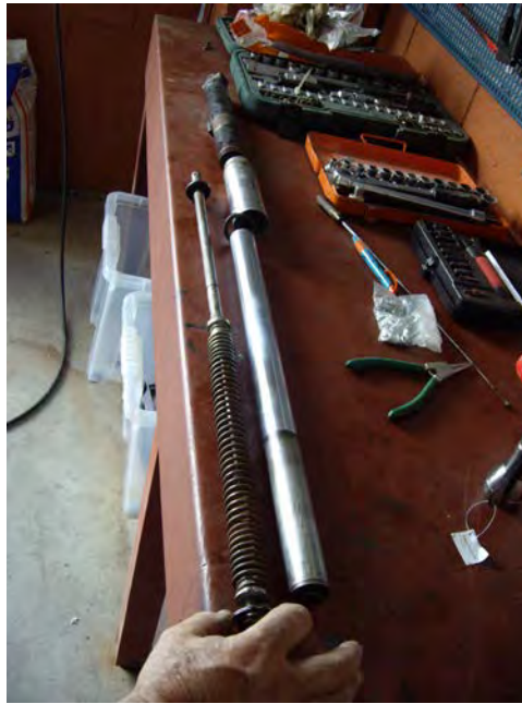
Detall de la suspensió original desmuntada
