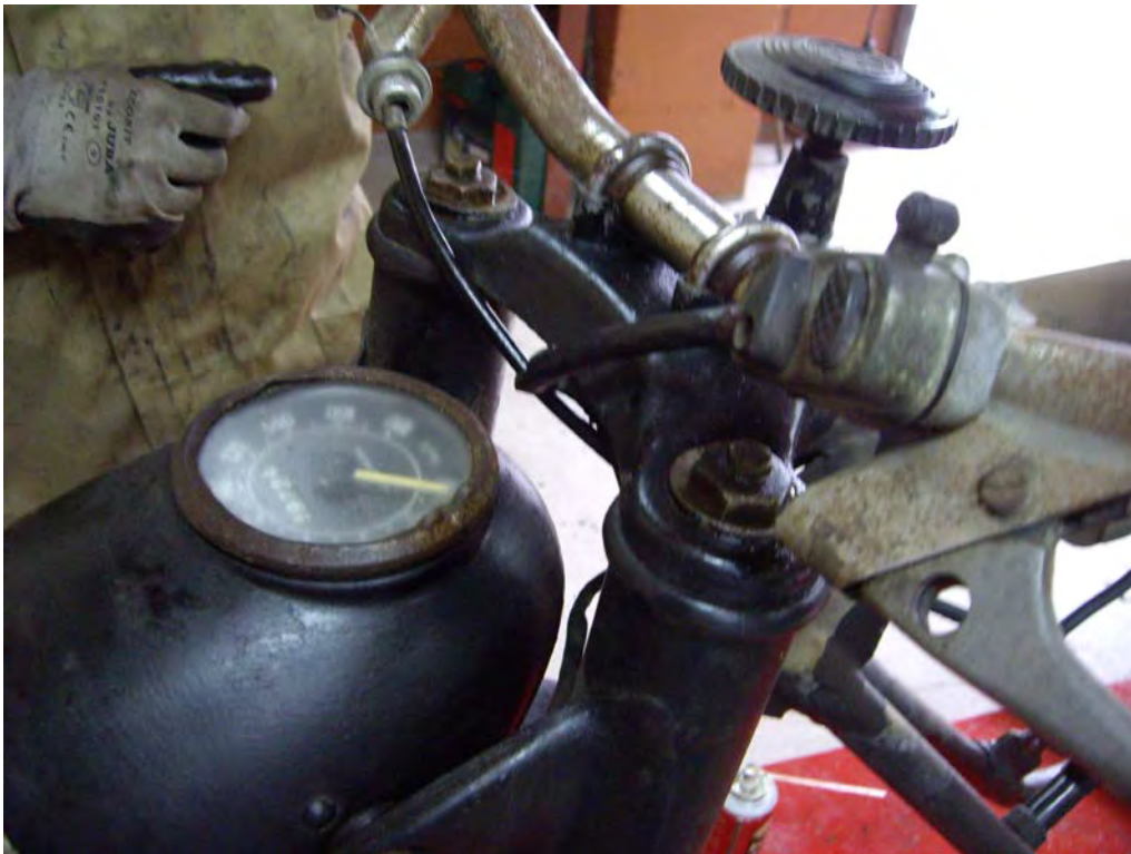
Instal·lació original del llum
