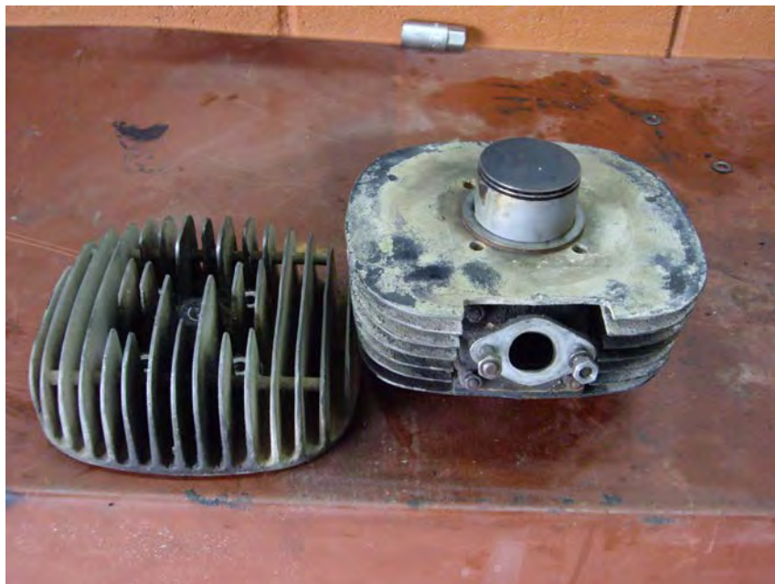
Cilindre, pistó i culata en l'estat original
