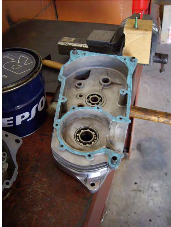
Carter polit amb els coixinets nous instal·lats
