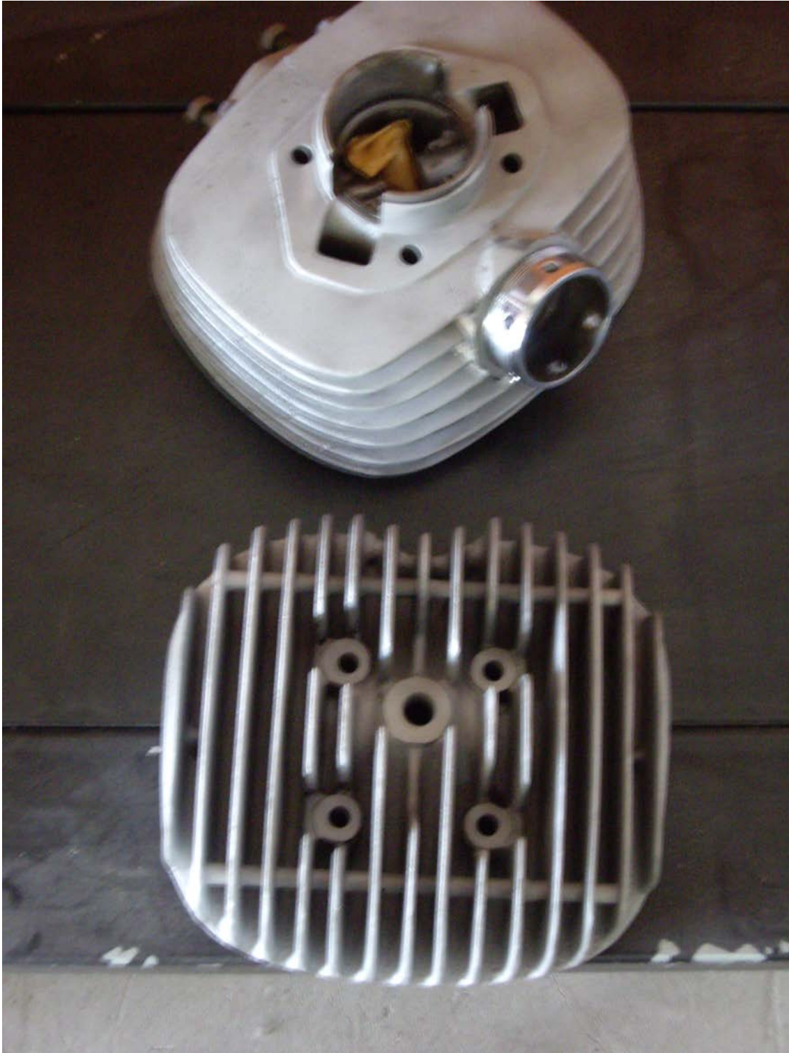
Cilindre, pistó i culata després de rectificar
