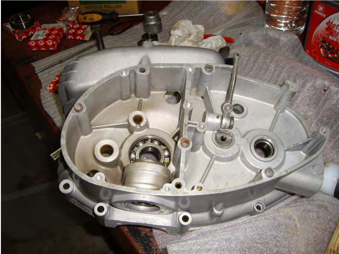
Col·locació dels coixinets nous
