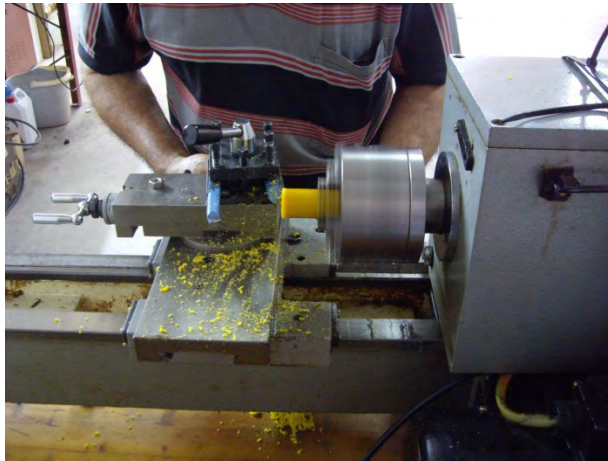
Fabricació de topalls i silentblocs amb el torn.
